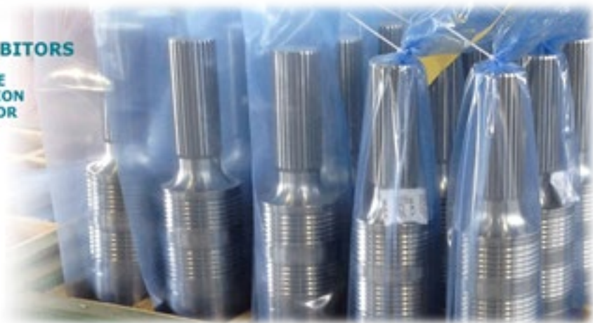
Beispiel Korrosionsschutzverpackung VCI: VCI Säcke + Desiccants Exemple d'emballage anticorrosion VCI : Sacs VCI + desséchants Ejemplo de VCI embalaje anticorrosivo: sacos VCI + desecantes
